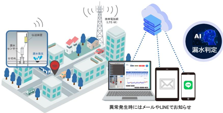
水道管路の付属設備(消火栓・仕切弁)に設置し、センサーで測定されたデータが携帯通信網を介しクラウドサーバーへ保存されます。
