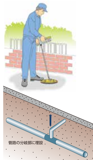
管路の探査例
